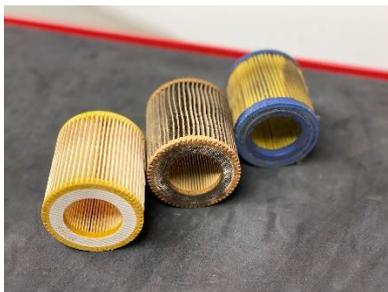
Figure 3 : Tapotez doucement le filtre à air pour éliminer la poussière sèche, les graines de plantes et les matières étrangères.
