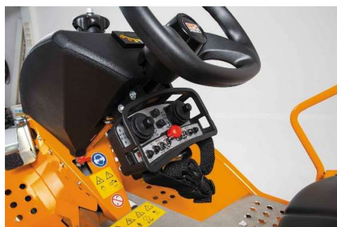
Illustration 5 : La télécommande professionnelle de la tondeuse autoportée télécommandée AS 940 Sherpa 4WD RC
