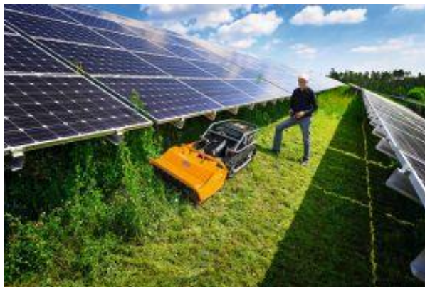
Illustration 6 : Il est important de ne pas marcher devant ou au-dessous la tondeuse lors de l'utilisation de tondeuses télécommandées comme le chenillard AS 751 RC
