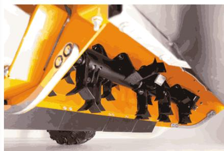
**Photo 4 :** La faucheuse à fléaux : si les fléaux touchent un objet étranger, ils peuvent se replier - un avantage décisif par rapport à la faucheuse à lames.
