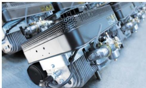
**Photo 3 :** La tondeuse adaptée aux pentes : équipée d'un moteur 2 temps, la lubrification du moteur est garantie indépendamment de la position de la machine, ce qui évite d'endommager le moteur dans les pentes. Pour les tondeuses à gazon et les tondeuses à herbes hautes, AS-Motor est aujourd'hui le seul fabricant de moteurs 2 temps.
